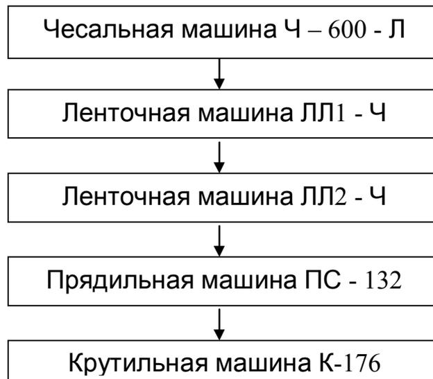
**Рис. 2. Технологическая цепочка получения льняного шпагата из короткого льняного волокна, полученного из низкономерной тресты**
