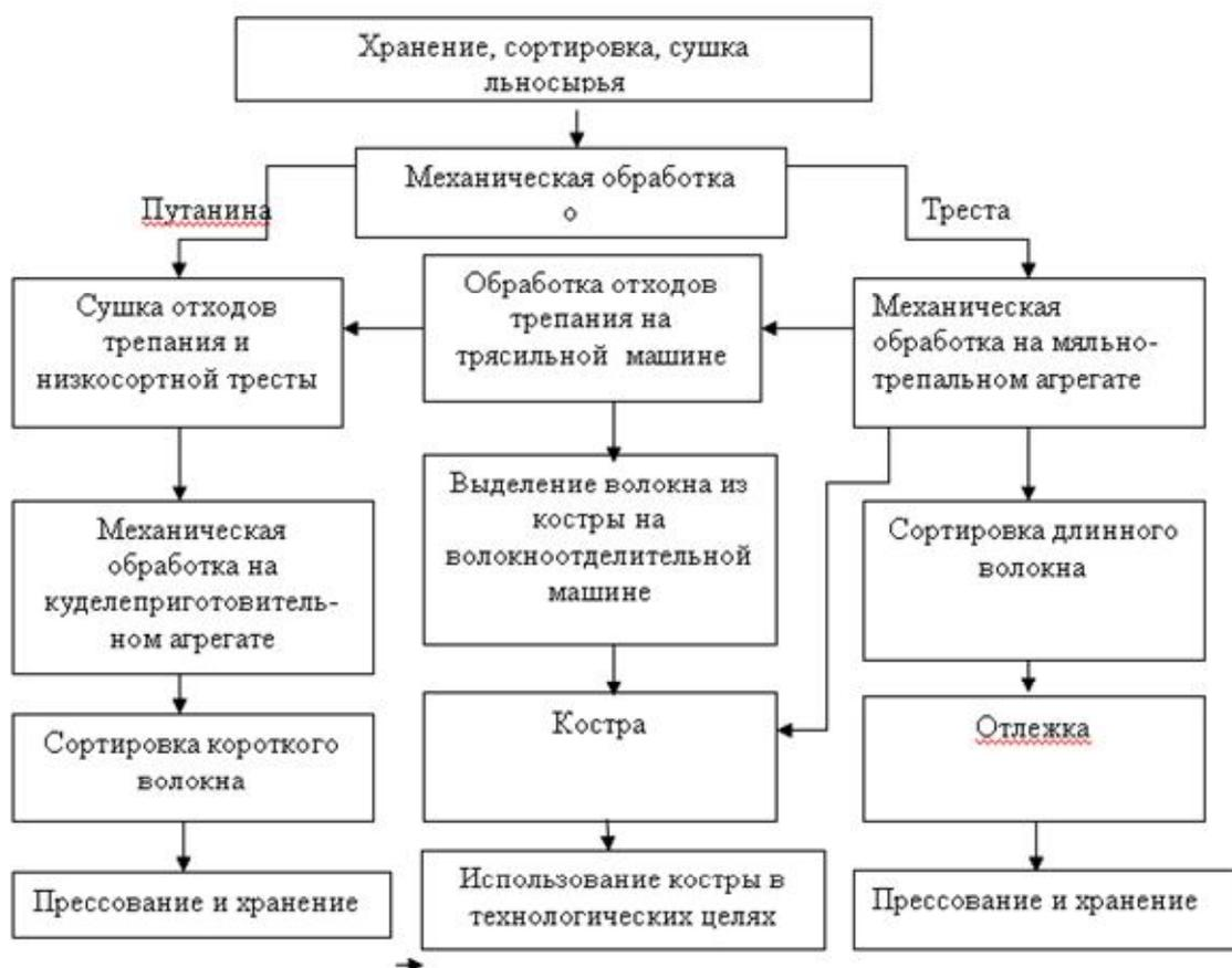
◀ Рис.1. Схема механической обработки льняной тресты
